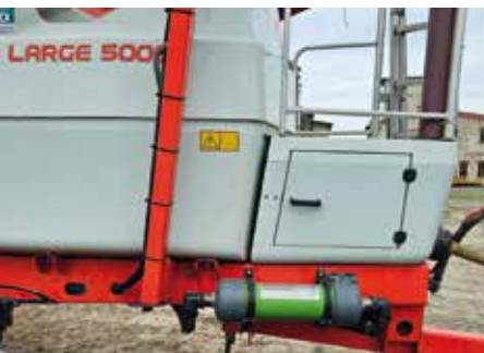
Feldspritze: Einbau in die Saugleitung
